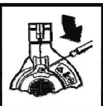
Instrucciones para la apertura de la cubierta de la toma de vacío.
