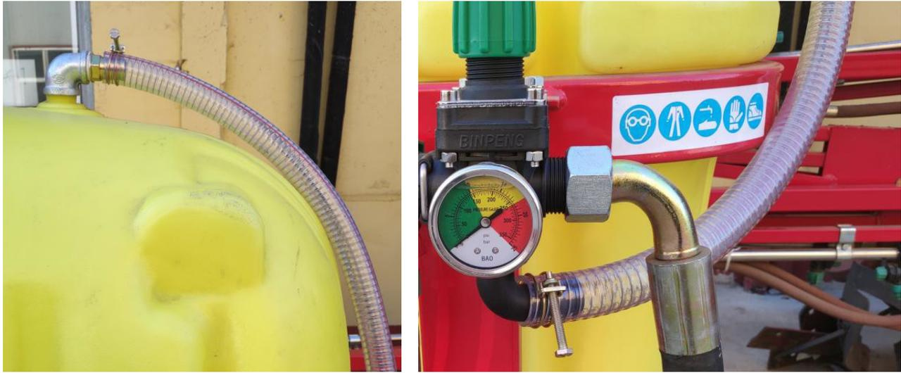
5. El filtro está ensamblado en la parte inferior de la estructura, y el codo del filtro está conectado al codo de la bomba con un tubo de acero transparente. La conexión en la parte inferior del tanque y la conexión recta del filtro están conectados también con un tubo de acero transparente.
