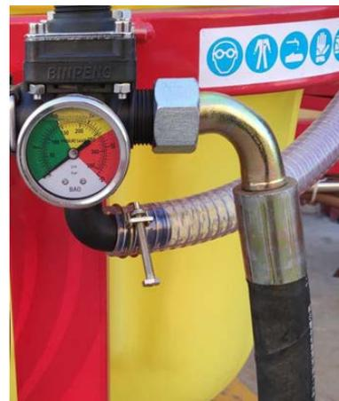
8. Ajuste la presión. La presión no debería tocar la zona pintada en rojo para evitar que la herramienta se dañe por alta presión.
