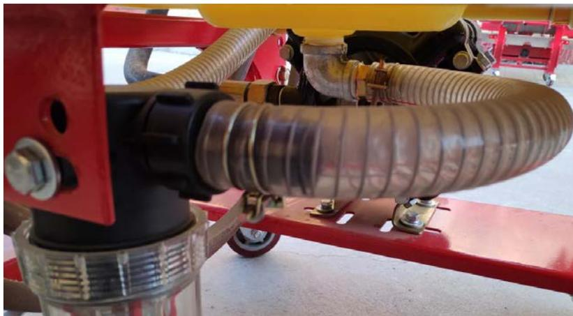
6. Ensamble el mezclador con una manguera de 1 metro de longitud y conecte el otro extremo de la manguera al distribuidor de agua.
