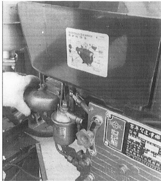
**Abra la palanca de control de velocidad; abra la palanca de descompresión**
