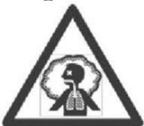
Al soldar se producen gases y vapores que, si se aspiran, pueden ser peligrosos para la salud. Mantenga su cabeza lejos de los vapores. No respire los vapores.
