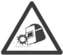
Los rayos del arco que se producen al soldar producen rayos intensos, visibles e invisibles (ultravioleta e infrarrojos) que pueden quemar la retina o la piel. Al soldar también se producen chispas.
